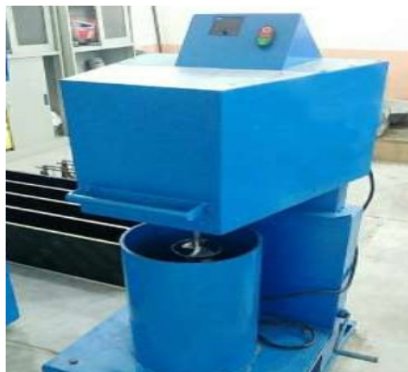
Figura 11 – Abrasímetro Hidráulico com dispositivo rotativo acoplado e velocidade ajustável no maquinário.
