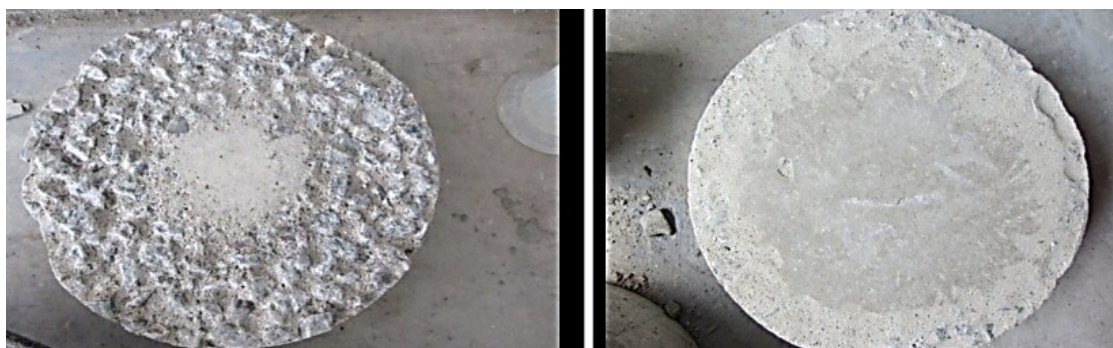
Figura 22 – Discos de concreto geopolimérico e concreto convencional respectivamente após o ensaio de abrasão hidráulica.
