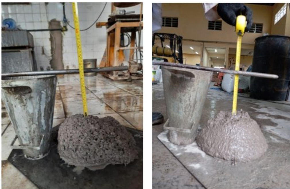
Figura 39 – Ensaio de abatimento do tronco de cone do concreto convencional e geopolimérico respectivamente.
