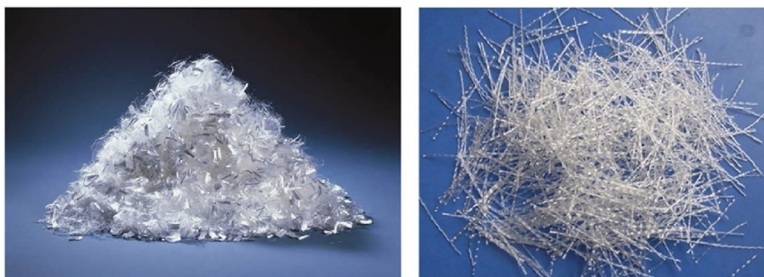
Figura 42 – Microfibras e macrofibras sintéticas de polipropileno.
