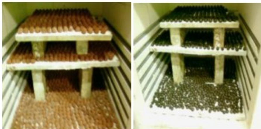
Figura 17 – Agregado sintético do resíduo da bauxita moldados manualmente antes e pós queima a 1200°C.
