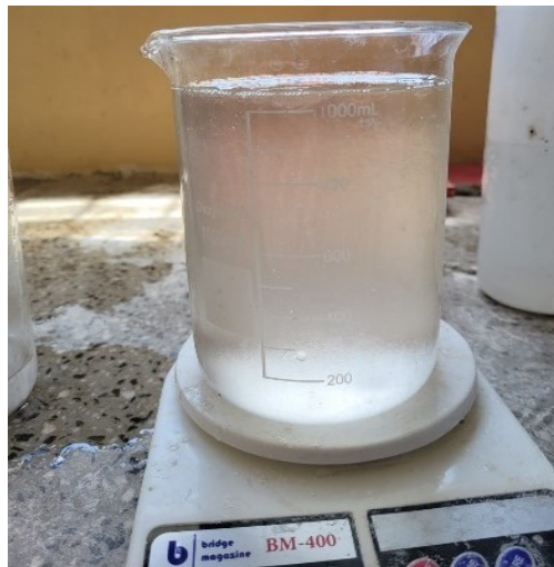
Figura 32 – Ativador alcalino com silicato de sódio neutro misturado com hidróxido de sódio.
